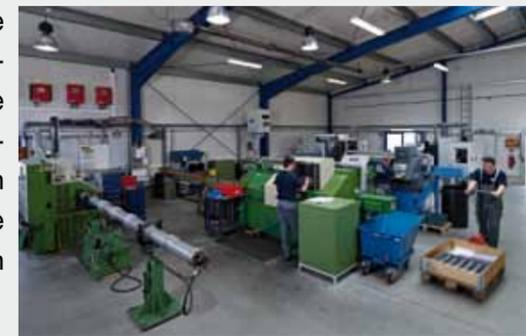
In allen Fertigungsabteilungen bearbeiten wir eine Vielfalt von Materialien, in deren Auswahl uns keine Grenzen gesetzt sind. Die verwendeten Werkstoffe erstrecken sich von Metallen wie Stahl, Edelstahl und Niro über NE-Metalle wie Aluminium, Messing und Kupfer bis hin zu den verschiedensten Kunststoffen.
